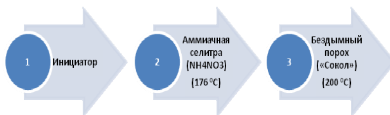
Рис. 6. Схема последовательности горения пиротехнического состава №4.
