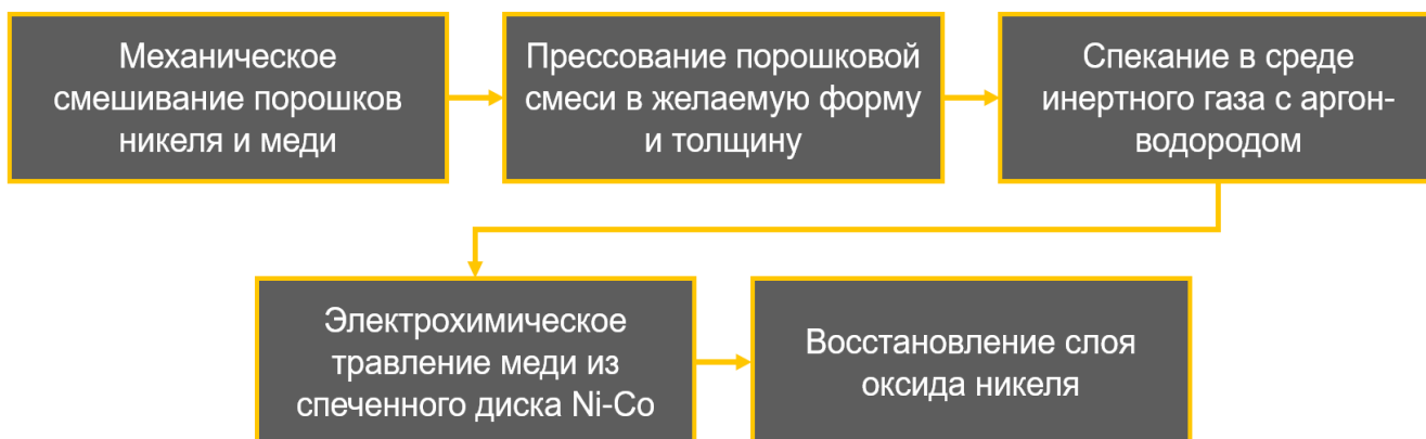
Рис. 1. Основные стадии изготовления пористого никеля путем селективного электрохимического травления.
