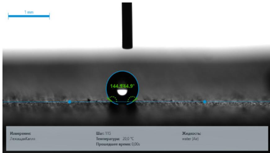
Рис. 3. Краевой угол смачивания лака №3 на поверхности бумаги.
