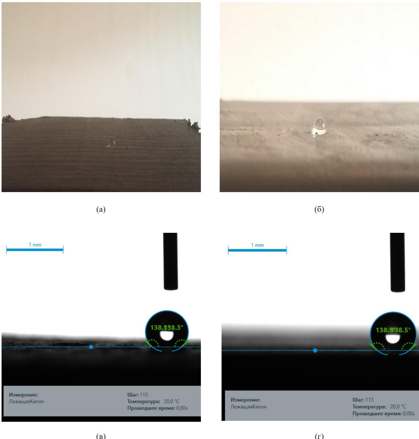
Рис. 4. Капли на образце №3 в основании которого (а) дерево; (б) металл; краевой угол смачивания капли на образце №3 в основании которого (в) дерево; (г) металл.
