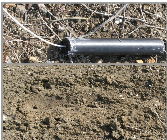
Рис. 5. Определение критического диаметра детонации и критической плотности взрывчатого вещества на испытательном полигоне.
