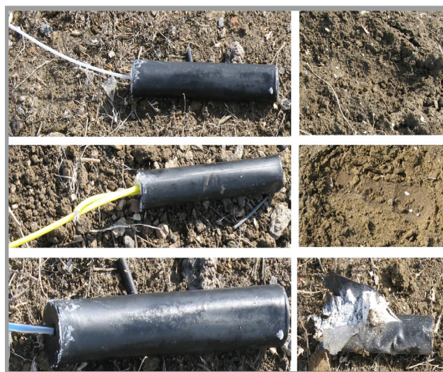
Рис. 6. Определение минимального инициирующего импульса взрывчатого вещества на испытательном полигоне: (а) – к капсулю-детонатору; (б) – детонирующему шнуру; (в) – огнепроводному шнуру.
