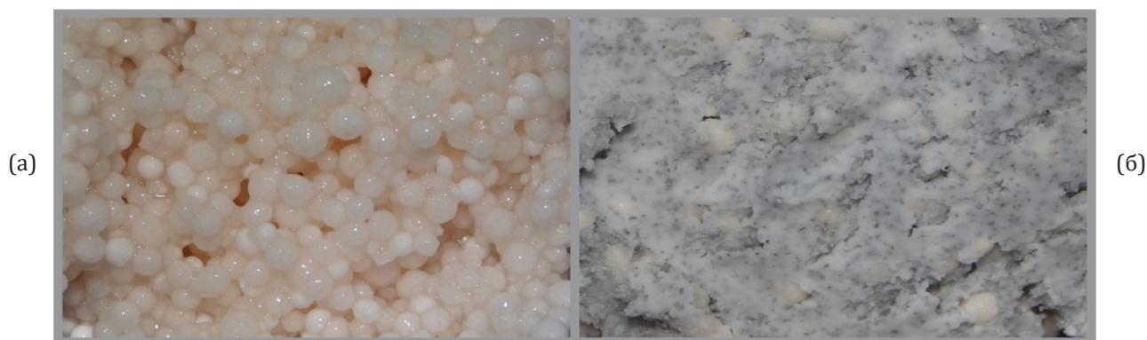
Рис. 1. Виды эмульсионных взрывчатых составов ((а) – тяжелое ANFO; (б) – капсулочувствительный эмульсионный состав).
