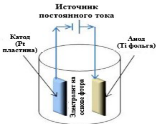
Рис. 1. Схематическое изображение двухэлектродной ячейки для получения \text{TiO}_2 электрохимическим анодированием.
