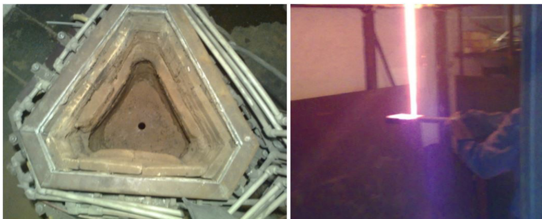
Рис. 8. Плавильная камера после технологических плавок и отбор проб струи расплава.
