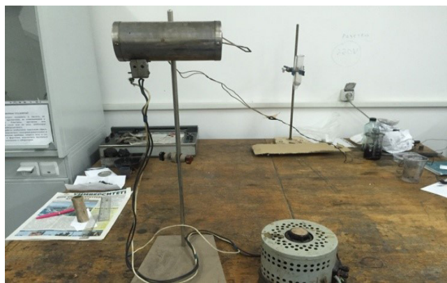
Рис. 1. Реактор для определения температуры вспышки. Горение состава изучали в реакторе для сжигания при атмосферном давлении.
