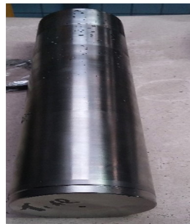
Рис. 9. Электрод для изготовления гранул ЖМ TiAl/Cr-Co.
