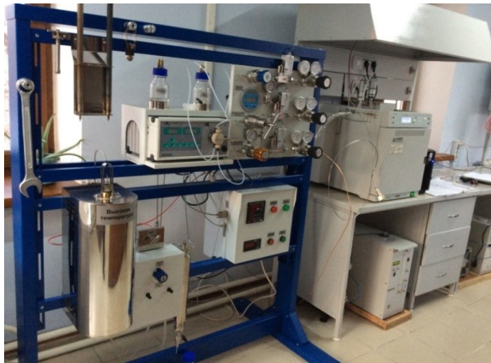
Рис. 1. Автоматизированная проточная каталитическая установка высокого давления (ПКУ-2 ВД).
