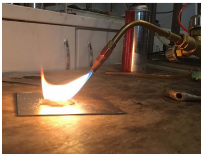
Рис. 2. Фотография пламенного метода нанесения углеродного гидрофобного слоя.
