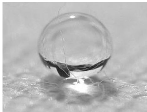
Рис. 2. Капля воды на ткани, обработанной гидрофобным составом [12].
