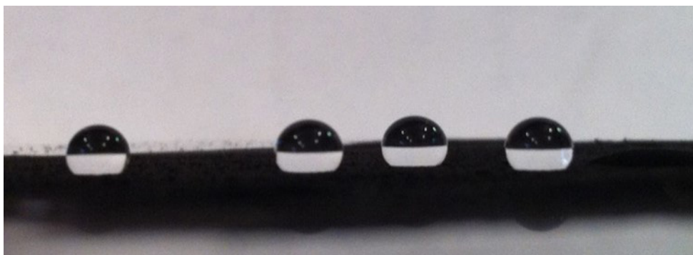
Рис. 9. Капли воды на сажевой поверхности полученной при горении продуктов разложения полиэтиленовых отходов [29].
