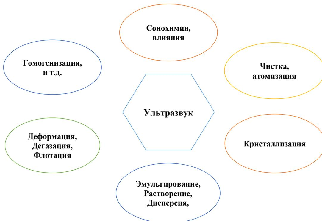
Рис. 1. Основные области использования ультразвука в химико-технологических процессах [10].
